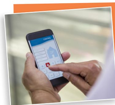
**QU'EST-CE QU'UNE GTB ?** C'est un système électronique et numérique qui gère les variables des bâtiments tels que chauffage, climatisation, ventilation, électricité ainsi que tous les équipements tels que les ascenseurs, les alarmes, les contrôles d'accès, la vidéo surveillance, ...
